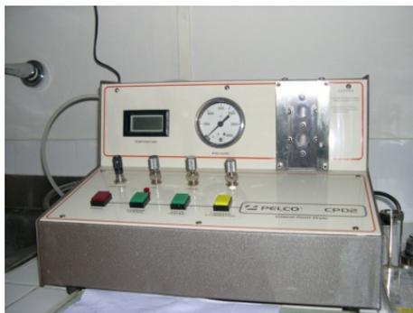
Figura 10 - Aparelho de ponto crítico utilizado para desidratação sob pressão (Critical Point Dryer - Pelco CPD2).
